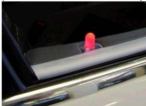
Anzeige des Status der Gaswarnanlage durch Blinkende LED-Türpins
